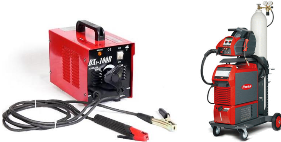
Şekil 13.11 Sıvalı elektrot kaynağı ve gazaltı elektrik ark kaynağı kaynak makinaları
