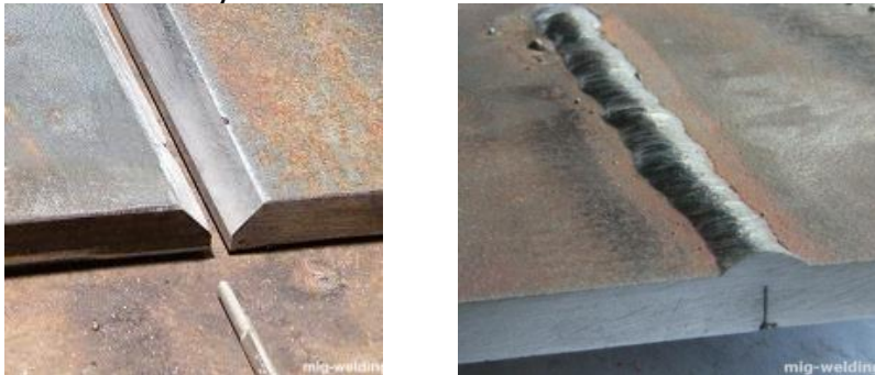
Şekil 13.14 Y şeklinde kaynak ağızı açılmış numune ve küt kaynak yapılmış durum
